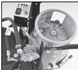
Tanque de gas con llenado de seguridad a 80%. Todos los componentes del sistema de gas tienen aprobación UL.
