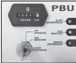
El control de emisiones Carb Gard™ detendrá un motor con alto nivel de emisiones en el escape. El LED de aviso está a plena vista del operador.
