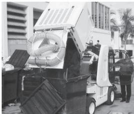
La tolva en acero inoxidable de la máquina, para múltiples vaciados, retiene un máximo de 1.3 metros cúbicos de basura. Y alcanza alturas de hasta 160 cm., para vaciarla sin esfuerzo en casi cualquier compactadora, contenedor o recipiente.
