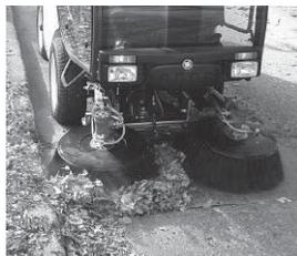
El flujo concentrado de aire atrapa el escombros pesado y partículas pequeñas. El flujo de aire tiene "sistema de levantamiento" que permite a la basura pasar directamente a través de la manguera de succión hacia la tolva
