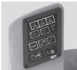
Activación One-Touch™ del sistema de restregado. Todos los sistemas arrancan y se detienen con el movimiento de la máquina.
