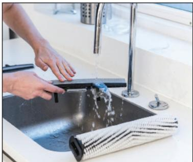
16. Limpia las cuchillas del squeegee y el cepillo cilíndrico con agua. Revisalos y reemplaza de ser necesario.
