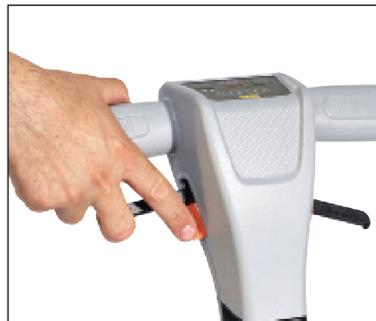
8. Para la función de barrido, levanta/bloquea la palanca derecha para levantar el squeegee frontal y así recolectar los residuos pequeños.
