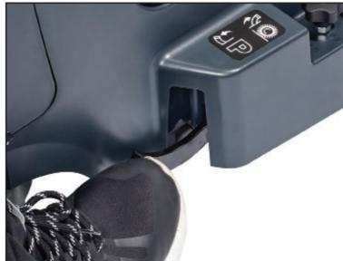
11. Para transportar y estacionar el equipo, presiona el pedal (levanta ligeramente el frente de la máquina inclinando el manubrio..
