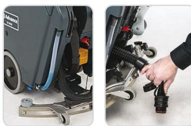
La manguera de vaciado de la solución con indicador de nivel. Manguera de drenado del tanque de recuperación con zona flexible para controlar el flujo manualmente.
