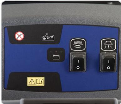
Panel de control intuitivo. El operador puede manejar la SC450® con solo 2 botones y un interruptor.
