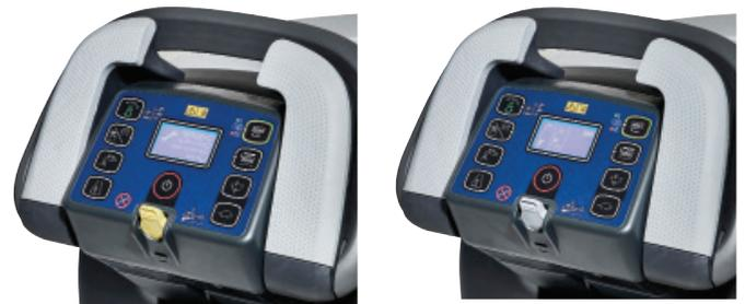
Cada faceta de la SC500 ha sido afinada para una experiencia de usuario óptima. Sus únicas pantalla multi función y panel de control otorgan a los supervisores - usando la clave de Super Usuario - acceso para ajustar los parámetros de limpieza. Los operadores - utilizando la clave gris - son capaces de empezar a limpiar desde el comienzo de su turno. No necesitan perder tiempo para cambiar la configuración del equipo antes de comenzar.
