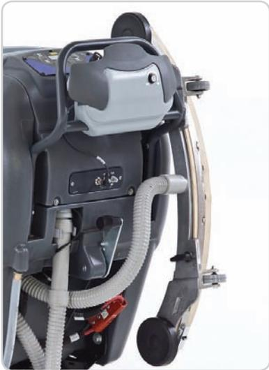
Un gancho integrado para el squeegee facilita el transporte y reduce los accidentes por tropiezos y caídas.
