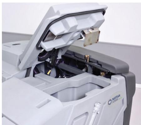
La máquina se puede limpiar fácilmente gracias a que la cubierta de la tolva se encuentra en la parte exterior con la bandeja de residuos.
