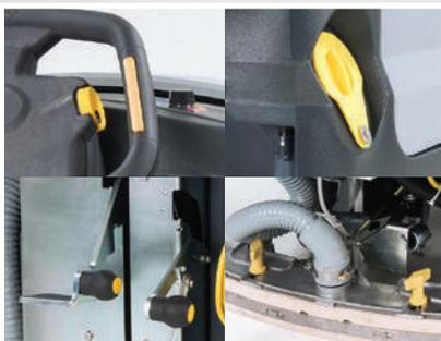
Puntos de seguridad amarillos que permiten al equipo ser fácil de usar y eliminar los errores cometidos por el operador.
