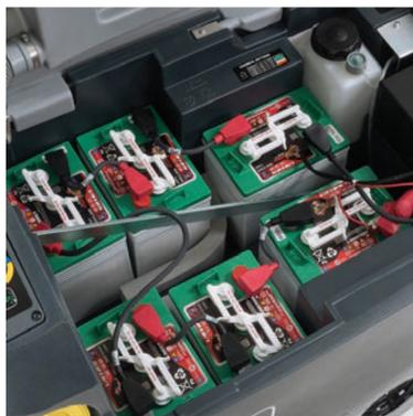
1. Revisa el nivel de las baterías y agrega agua destilada de ser necesario.
