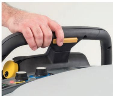
7. Presiona el interruptor amarillo ubicado en la parte trasera del manubrio para ir en reversa.
