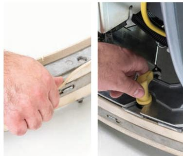
3. Revisa las lámina del squeegee y da la vuelta o reemplaza de desgaste o desgarré. Instala el squeegee y aprieta las tuercas.
