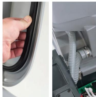
3. Revisa el empaque del tanque de recuperación y las mangueras.
