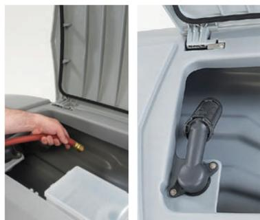
16. Enjuaga el tanque de recuperación y deja la tapa abierta para su secado. Revisa la caja del flotador.
