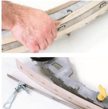
1. Inspecciona el squeegee en caso de desgaste y reemplaza de ser necesario.
