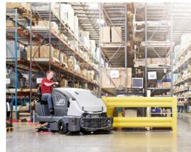
SmartFlow™ ajusta el flujo de solución con la velocidad de la máquina, utilizando agua y productos químicos. Proporcionalmente mayor productividad con menos volcado y ciclos de llenado por tanque
