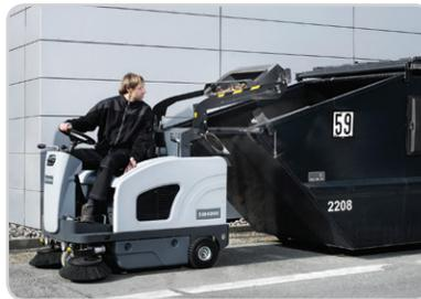
La descarga alta de desechos hidráulica permite un vaciado rápido. La tolva retráctil minimiza el largo de la máquina para brindar la mejor maniobrabilidad de su clase.
