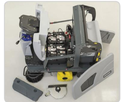
La SW4000® ofrece MaxAccess con remoción de la cubierta lateral sin uso de herramientas para dar un acceso total al compartimento de la batería y a los componentes de la transmisión del cepillo principal.
