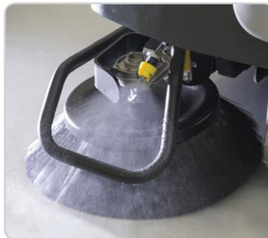
El sistema opcional de rociado de agua DustGuard® brinda un ancho de barrido con control del polvo hasta 75% mayor para una calidad superior del aire en interiores y optimiza la eficiencia de barrido.
