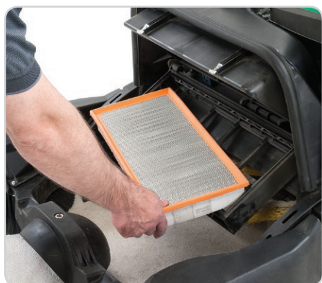
Sistema de filtración de alta capacidad de una etapa para un control de polvo más efectivo. Acceso al filtro sin necesidad de herramientas.
