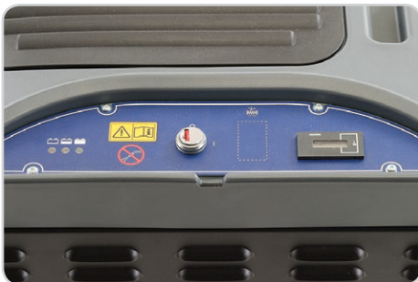
Panel de control con interruptor principal, indicador de carga de batería y contador de horas de uso
