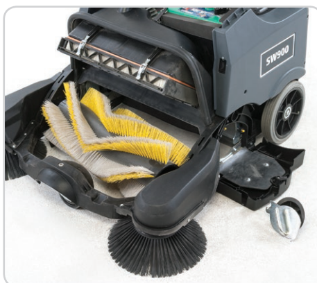
Ahorro de tiempo en mantenimiento: reemplazo de cepillos y otras tareas de mantenimiento rutinario sin necesidad de herramientas.
