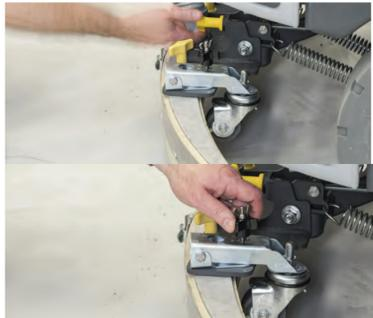
7. Comprueba la altura del squeegee ajustando las ruedas giratorias y su ángulo.
