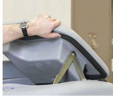
4. El sello de tanque de recuperación debe estar correctamente instalado y en perfecta condición.
