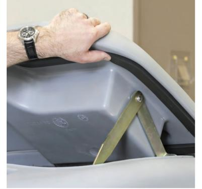
4 El sello de tanque de recuperación debe estar correctamente instalado y en perfecta condición.
