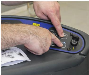
16. En caso de que algo no funcione de la manera correcta, ponga la máquina en modo de Test de Servicio presionando el interruptor de Velocidad y después el Control de Tracción, posteriormente presiona Ir al menú.
